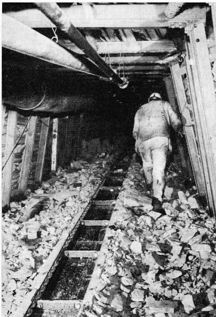
Met een variant op het spreekwoord: waar gehakt wordt vallen spaanders, kunnen wij hier zeggen: waar geschoten wordt vallen stenen. Een kijkje in steenstelling 387 a, waar afdelings-opzichter J. H. Janssen op weg is naar kop steenhelling. Met behulp van de transporteur worden de stenen later weggevoerd.
